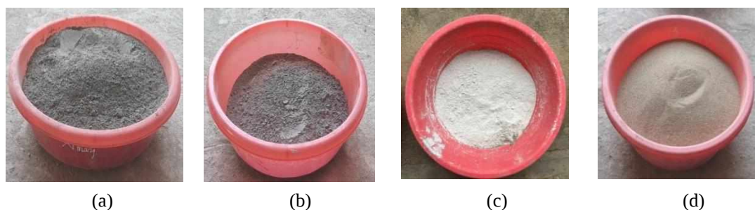
Hình 1. Vật liệu thí nghiệm a) xi măng, b) silica fume, c) xỉ lò cao nghiền mịn và d) cát
