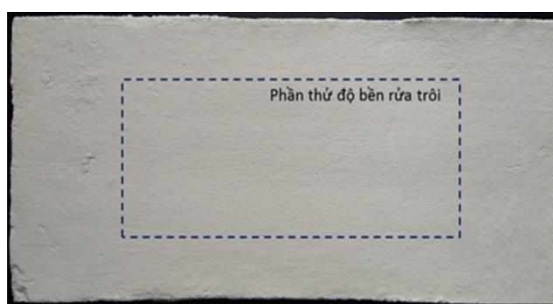
Hình 4. Ảnh chụp bề mặt mẫu sơn chứa 10% tro bay thử nghiệm độ bền rửa trôi 1200 giờ
