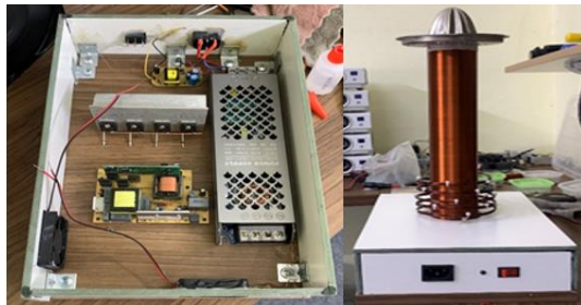
Hình 5. Mô hình hệ thống truyền tải điện không dây ở khoảng cách trung bình
