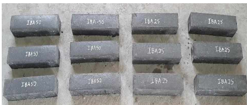
Hình 2. Hình ảnh các mẫu vữa sau khi tháo khuôn
