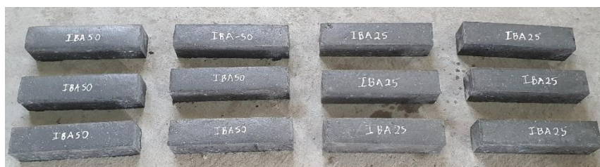
Hình 2. Hình ảnh các mẫu vữa sau khi tháo khuôn
